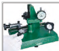
Test de fuerza para los relojes analógicos
